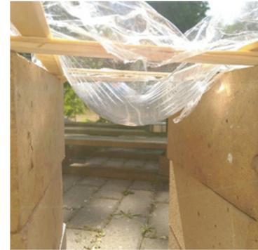
Sie werden sehen, dass das Licht durch die „Wasserlinse“ gebündelt wird und diese Bündelung an einer bestimmten Stelle zu einem Brennpunkt führt. Sie finden den Brennpunkt indem Sie nach dem hellsten Punkt suchen. Halten sie ein trocknes Laubblatt oder einen anderen leicht entzündlichen Gegenstand in diesen Brennpunkt, fängt es nach 10 Sekunden an mit qualmen und langsam gelingt es Ihnen ein Loch in das Blatt zu brennen!
